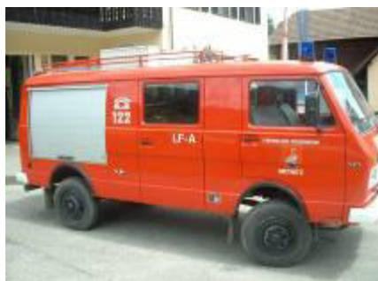
**LFA (Löschfahrzeug Allrad):** Durch das mitgeführte hydraulische Rettungsgerät ist das LFA das erste Fahrzeug, das bei einem Verkehrsunfall ausrückt. Zusätzlich kann dieses Fahrzeug durch eine mitgeführte Tragkraftspritze auch bei Brandeinsätzen eingesetzt werden.
