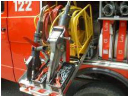
**Hydraulisches Rettungsgerät:** Leider nimmt auch in unserer Gemeinde die Anzahl an schweren Verkehrsunfällen zu. Um eine Rettung von Personen aus deformierten und verkeilten Fahrzeugen durchführen zu können, kommen hydraulische Rettungsgeräte zum Einsatz. Gerade auf diesem Sektor hat sich in den letzten Jahren viel getan. Die Karosserien der Autos wurden immer mehr verstärkt und damit die primäre Sicherheit der Insassen
