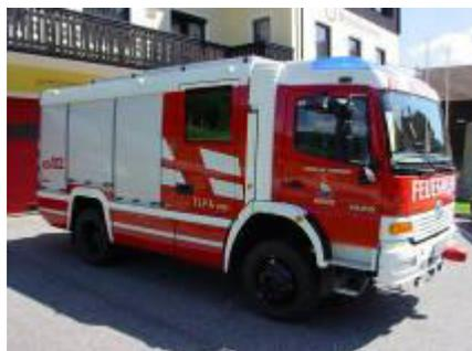
**TLFA (Tanklöschfahrzeug Allrad):** Dieses Fahrzeug ist mit einem 3000 Liter Tank, einer fix eingebauten Mehrbereichspumpe und Atemschutzgeräten ausgestattet. Es ist das wichtigste Fahrzeug bei einem Brandeinsatz. Zusätzlich ist es noch mit einer hydraulischen Seilwinde (5 Tonnen Zugkraft), einem Notstromaggregat, Lichtmast, Hebekissen und vielen Werkzeugen ausgerüstet, um ein großes Einsatzspektrum abdecken zu können.
