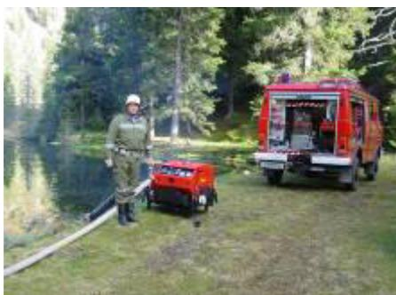
**Tragkraftspritzen:** Insgesamt stehen der Feuerwehr Metnitz 3 Tragkraftspritzen zur Verfügung. Mit einer Literleistung von bis zu 1600 Liter/min kann damit Wasser aus stehendem oder fließendem Gewässer, sowie über das
