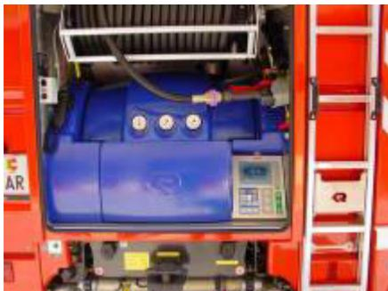
**Einbaupumpe des TLFA:** Diese Pumpe hat eine Leistung von bis zu 2000 Litern/min und wird über ein Computer-System gesteuert. Über diesen Computer kann der Maschinist jederzeit den Status der Pumpe, des Fahrzeuges und der Wasserreserve ablesen, gleichzeitig aber auch die Beleuchtung und Notstromversorgung steuern.
