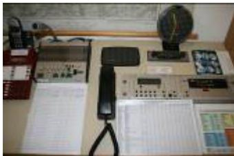
\*) Funkfixstationen: Im Rüsthaus befinden sich zwei fix eingebaute Funkstationen. Über diese Funkstationen läuft die Alarmierung (Piepser und Sirene), aber auch die Kommunikation zwischen den Einsatzkräften, benachbarten Feuerwehren und der Leitstelle ab.
