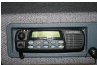
\*) Fahrzeugfunkgeräte: In jedem der vier Einsatzfahrzeuge der Feuerwehr Metnitz ist ein Funkgerät eingebaut. Wie bei den Funkfixstationen kann hier eine Verbindung zu den Einsatzkräften, wie auch zu anderen Feuerwehren aufgebaut werden.
