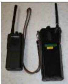
\*) Handfunkgeräte: Insgesamt stehen der Feuerwehr Metnitz 9 Handfunkgeräte zur Verfügung. Diese dienen zur Verständigung am Einsatzort und zur Kommunikation mit dem Rüsthaus. Die Reichweite ist auf wenige Kilometer eingeschränkt.
